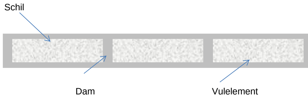
Figuur 1 - Principe doorsnede dunwandig lichtgewicht element
